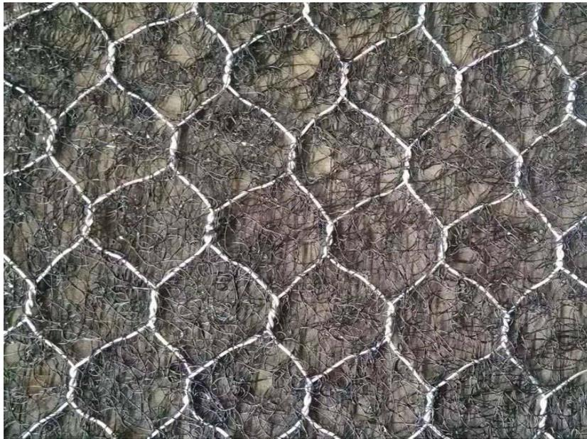
图5-5 锌铝合金2.2加筋麦垫/聚丙烯450克加筋麦垫示意图
